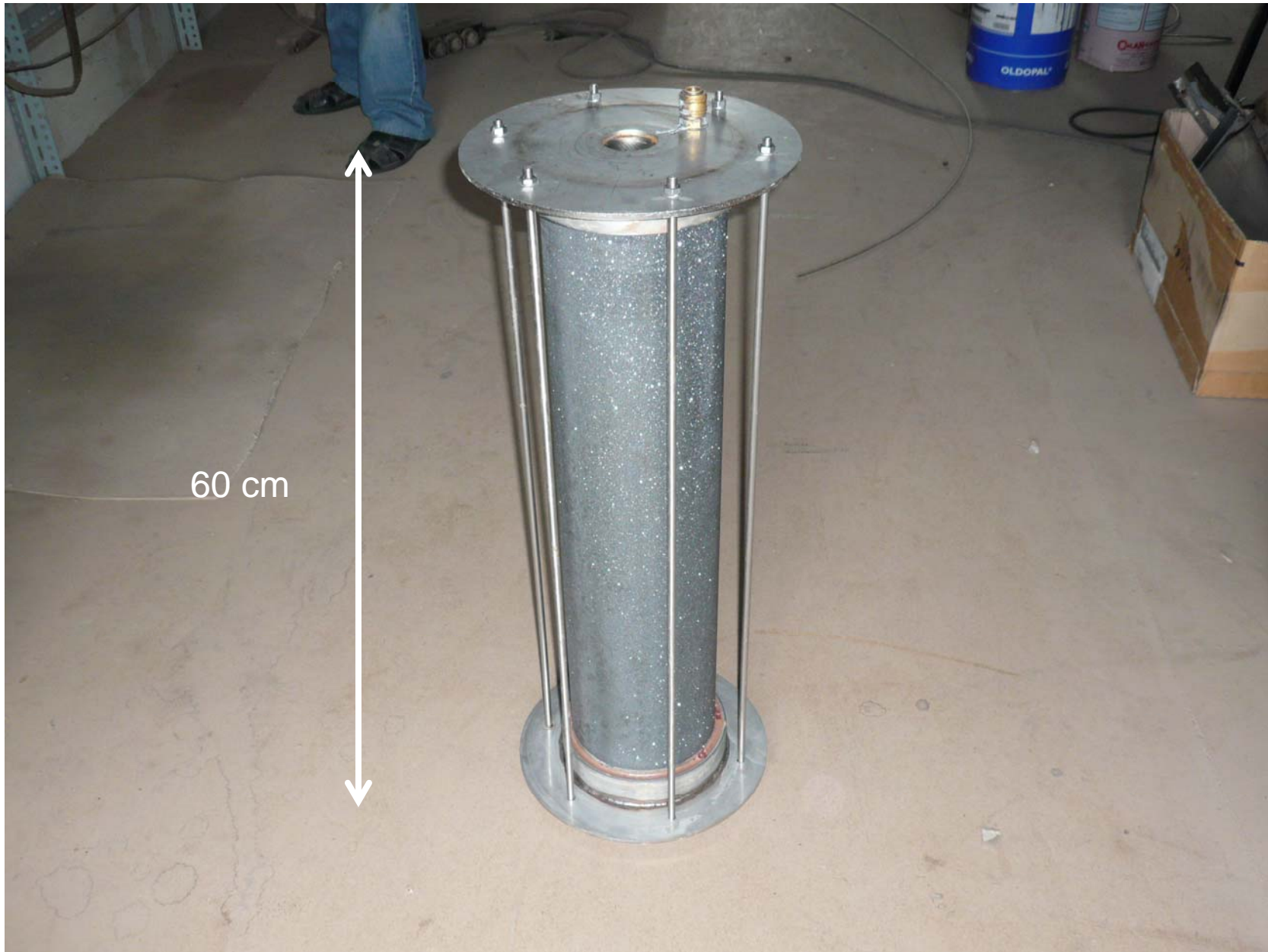
SiC-Rohr mit Anschluß für Luft, Druck-Stabilisierung durch 6 Stäbe
