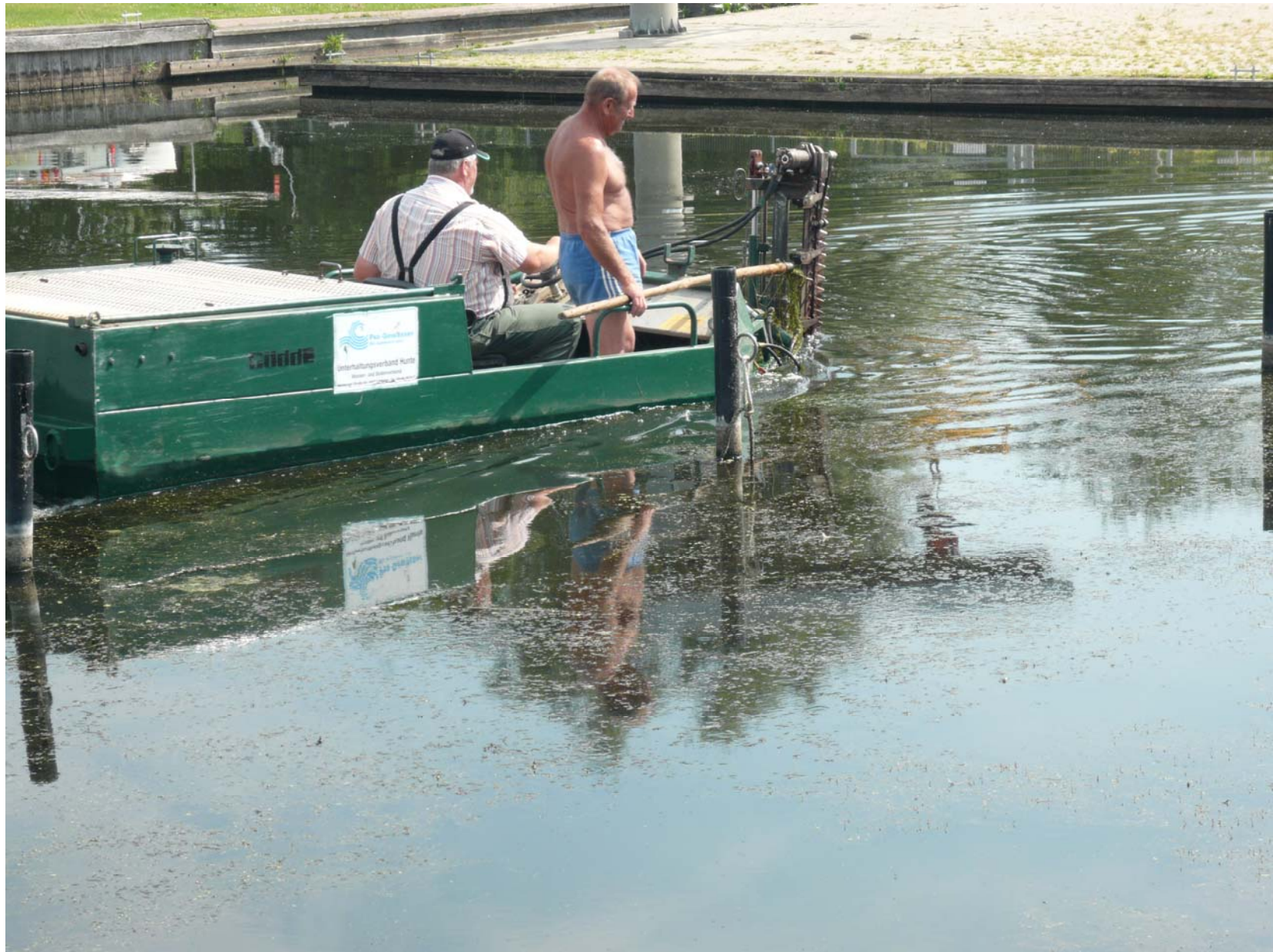
Mäh-Boot, Hunte-Unterhaltungsverband, in Aktion zum Abschneiden von Unterwasserpflanzen im SVH-Hafen im Juli 2013, erkennbar: dichter Bewuchs
