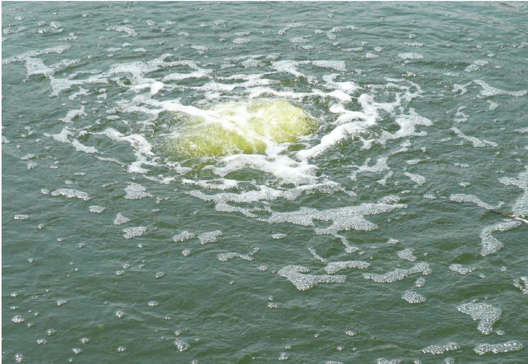
Lufteintrag und gebildete Luftblasen, Turbulenzen, im mittleren SCD-Hafenbecken Position des SiC-Rohres auf dem Boden des Hafenbeckens, ca. 1 m, 400 l-Luft/min, 25. Juli 2013
