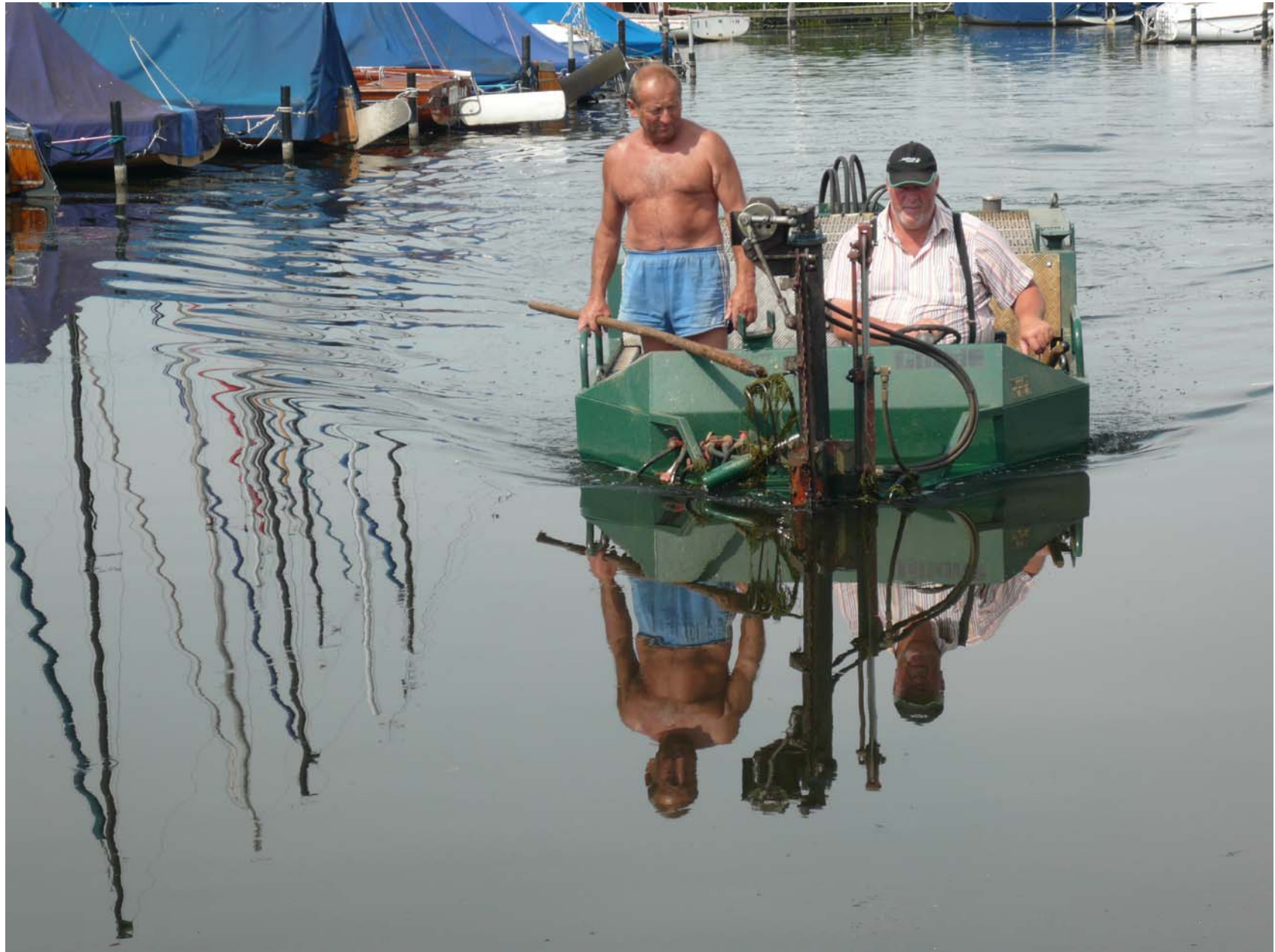
Mäh-Boot, Hunte-Unterhaltungsverband, in Aktion zum Abschneiden von Unterwasserpflanzen im SVH-Hafen im Juli 2013
