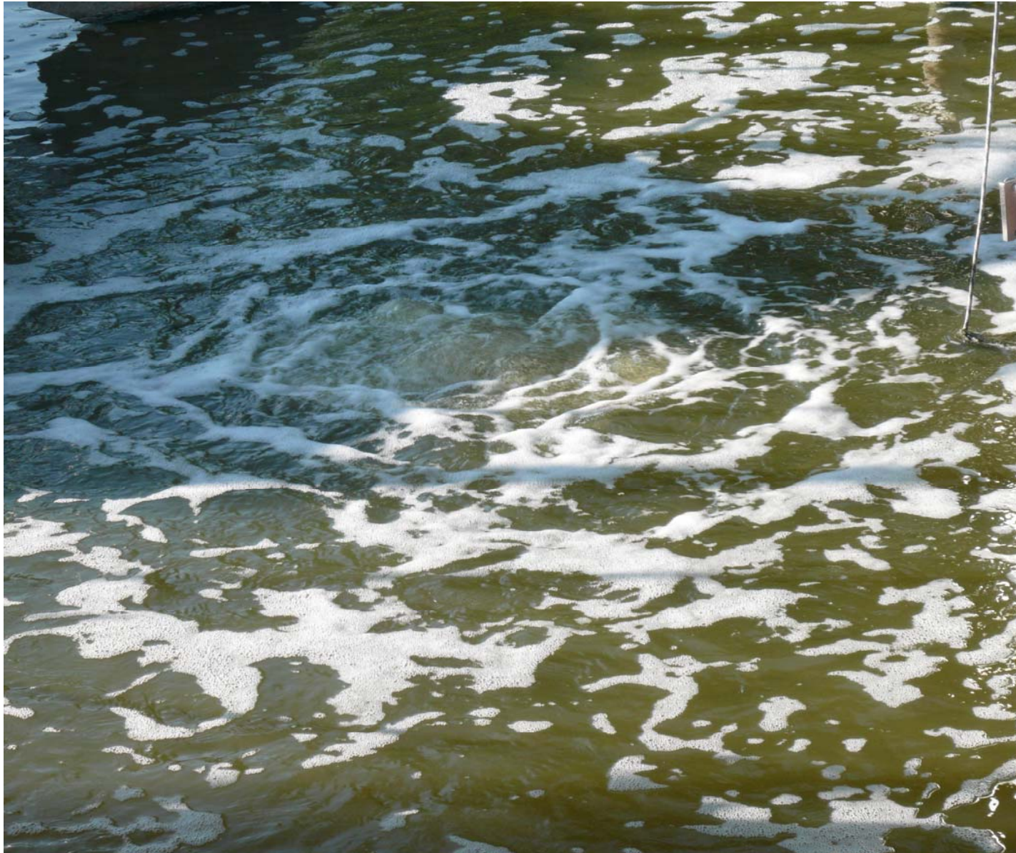
Lufteintrag und gebildete Luftblasen, Turbulenzen, im hinteren (östl.) SCD-Hafenbecken Position des SiC-Rohres auf dem Boden des Hafenbeckens, ca. 1 m, 400 l-Luft/min, 25. Juli 2013, teilweise Koaleszenz der Luftbläschen
