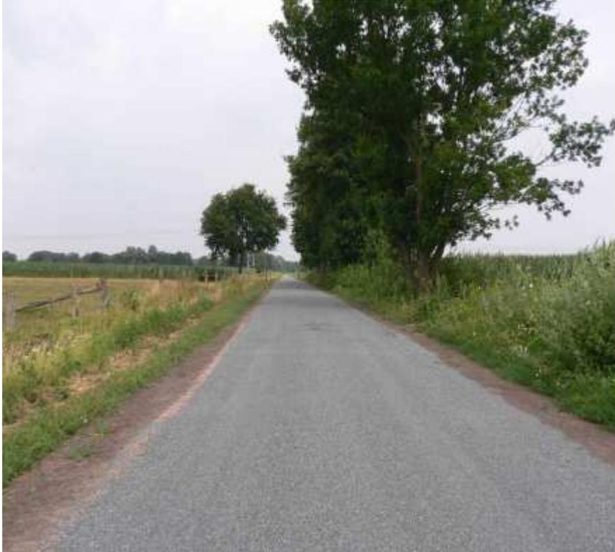
**Abb. 7 Beispiel eines Weges mit einer wassergebundenen Decke (DoB)**
